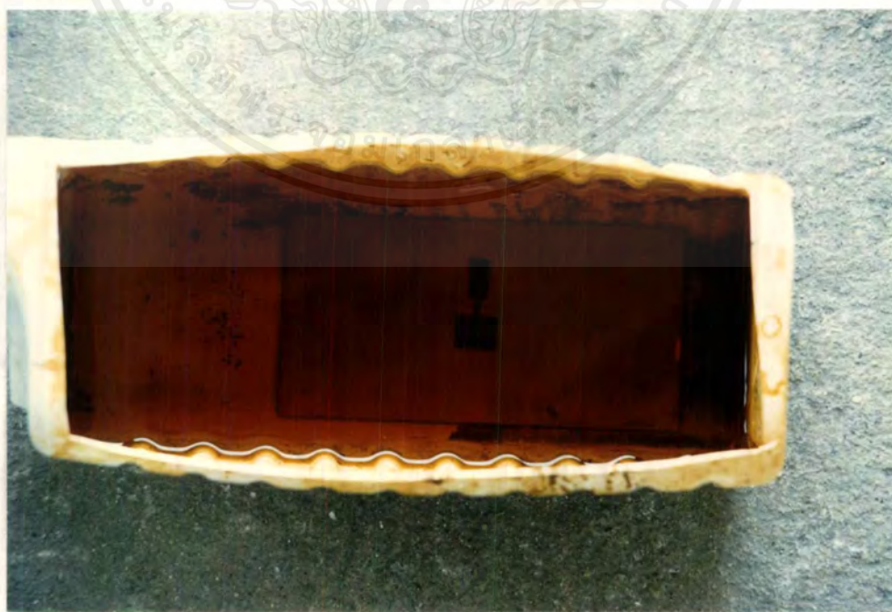
รูปที่ 39 แสดงการกัดแผ่น teflon โดยใช้น้ำยากัดแผ่นทองแดง
