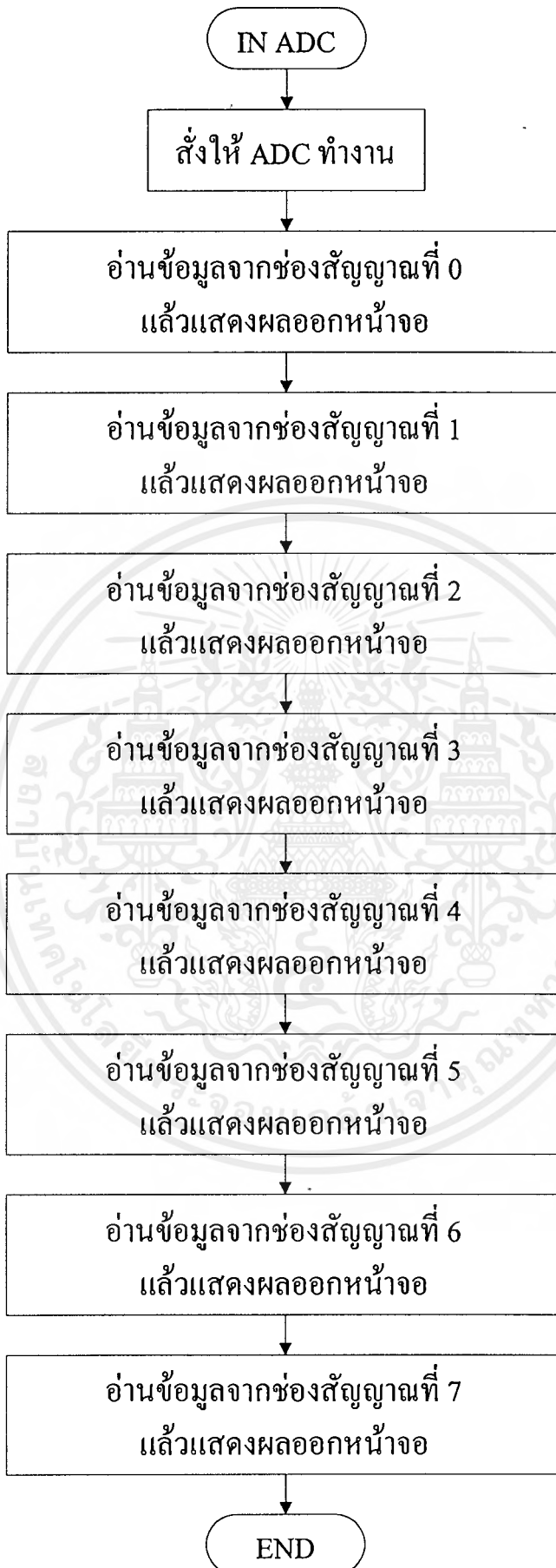
รูปที่ 6.5 โฟล์วชาร์ตแสดงโพธิ์ซีเยอร์ IN ADC
