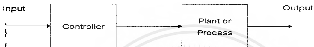
รูปที่ 2.8 ระบบควบคุมแบบ Open-loop
