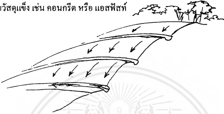
รูปที่ 3.44 แสดงทางระบายน้ำฝนบนไหล่เนิน
