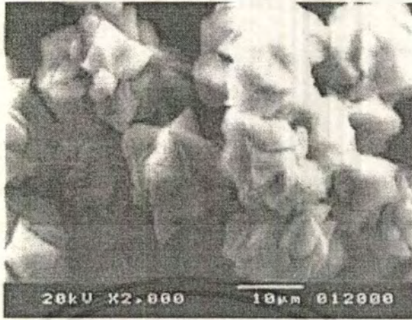
รูปที่ 4.4 แสดงภาพที่ได้จากกล้องจุลทรรศน์อิเล็กตรอนแบบส่องกราดของสารผลิตภัณฑ์ที่สังเคราะห์ได้ที่ใช้เวลาในการปั่นกวน 24 ชั่วโมง
