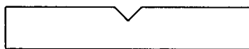
รูปที่ 3.2 แสดงลักษณะชิ้นงานที่ใช้ในการทดสอบสมบัติความทนต่อแรงกระแทก
