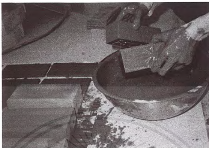
รูปที่ 3.15 แสดงวิธีการชุบ หรือจุ่มน้ำเคลือบ
