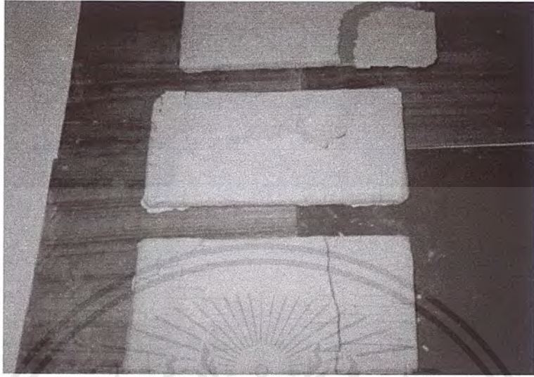
รูป ค. 11 ตัวอย่างกระเบื้องแตกหักเมื่อแห้งหลังจากชุบเคลือบ
