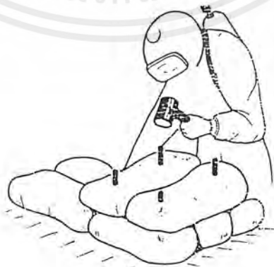
รูปที่ 2.5 แสดงการเทคอนกรีตได้น้ำโดยวิธี Bagwork
