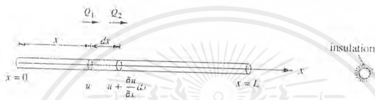
รูปที่ 2.4.1 แสดงการกระจายความร้อนตามแนวยาวของโลหะ
