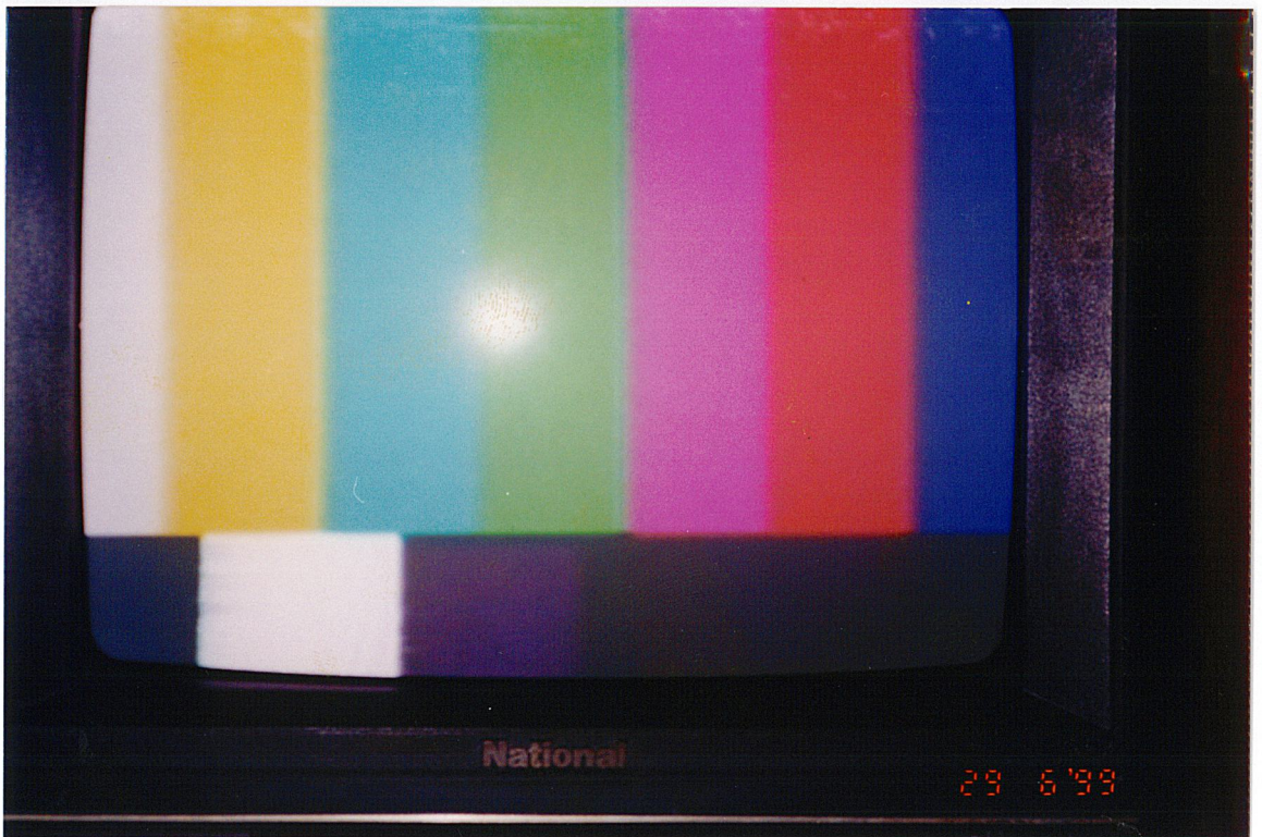
รูปที่ 4.9 แสดงภาพถ่ายของภาพโทรทัศน์ที่ได้จากการต่อสายสัญญาณโดยตรง จากเครื่องกำเนิดสัญญาณภาพเข้ากับโทรทัศน์โดยตรง
