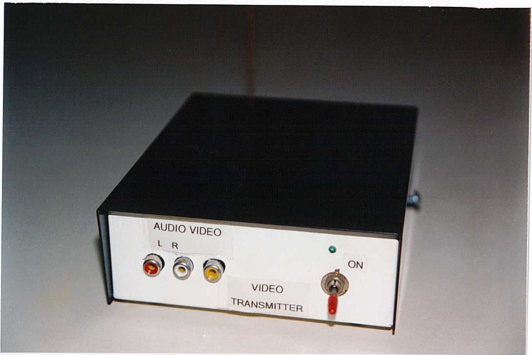
รูปที่ 4.5 แสดงภาพถ่ายของเครื่องส่งสัญญาณวิดีโอไร้สายที่สมบูรณ์
