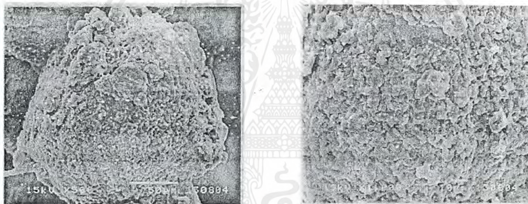
A : ไมโครสเฟียร์ที่มีความเข้มข้นของพอลิไวนิลแอลกอฮอล์ 15 % w/v มีความเร็วรอบการปั่นกวน 400 รอบ/นาที
