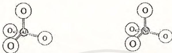
รูปที่ 2.1 tetrahedron ของ aluminium primary unit และ tetrahedron ของ silica primary unit [5]
