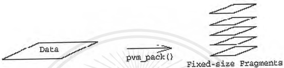
รูปที่ 3.16 การแตกข้อมูลเป็นข้อมูลเล็กๆขนาดคงที่
