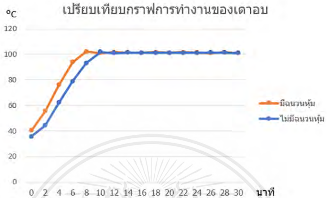
รูปที่ 4.5 แสดงการเปรียบเทียบการเพิ่มของอุณหภูมิภายในเตา
