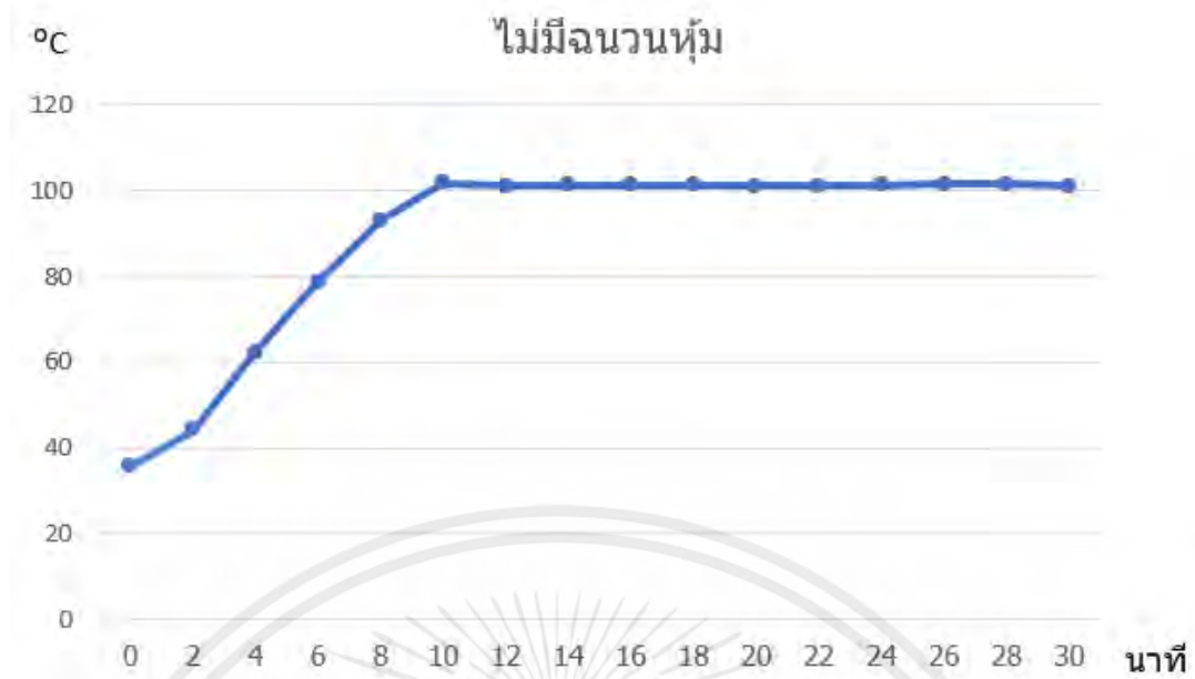
รูปที่ 4.3 แสดงผลการทดสอบและบันทึกค่าอุณหภูมิโดยไม่มีฉนวนหุ้ม
