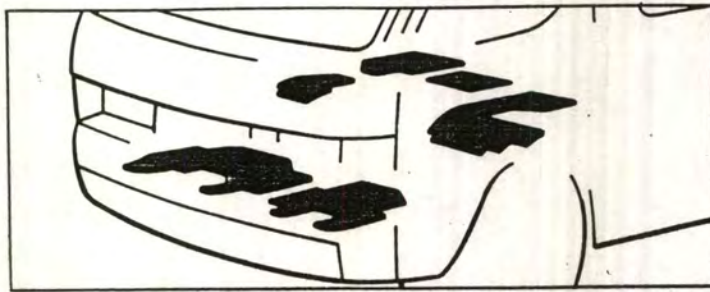
ภาพที่ 2.1.3.1.8 แสดงการเสริมวัสดุลดการสั่นสะเทือน ช่วยตัดเสียงรบกวน ภายในห้องโดยสาร
