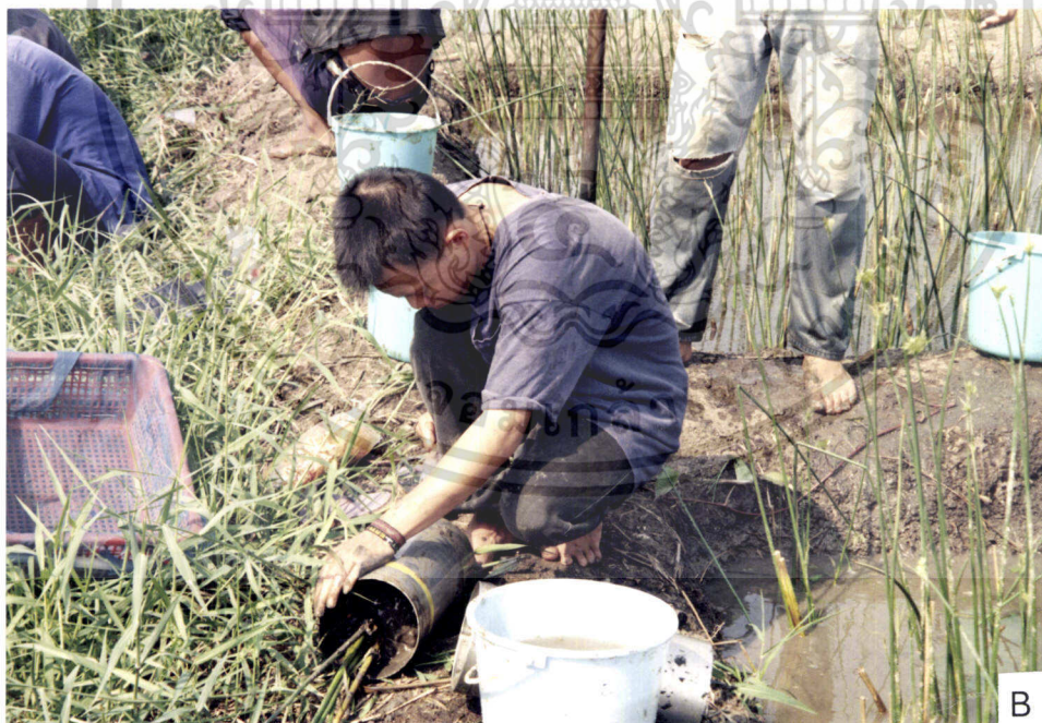
ภาพผนวกที่ 2 การเก็บตัวอย่างรากกกโดยวิธี core sampling method (A) และการเอา แท่งดินออกจาก metallic cylinder(B)
