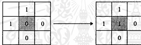
รูปที่ 4.13 แสดงตัวอย่างของจุดเกิดที่เดิมมีค่าเป็น 0 ถูกเปลี่ยนให้มีค่าเป็น 1
