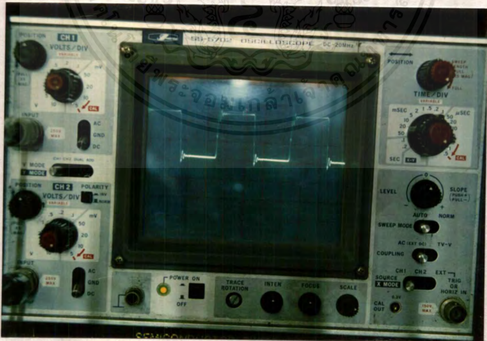
รูปที่ 4.16 แสดงสัญญาณแรงดันตกคร่อมมอสเฟต ( V_{DS} ) ขณะทำงานที่ความถี่สูงกว่ารีโซแนนซ์
