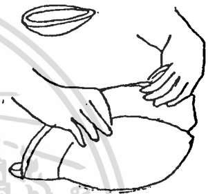
การขึ้นรูปด้วยวิธีกดลงบนต้นแบบ
