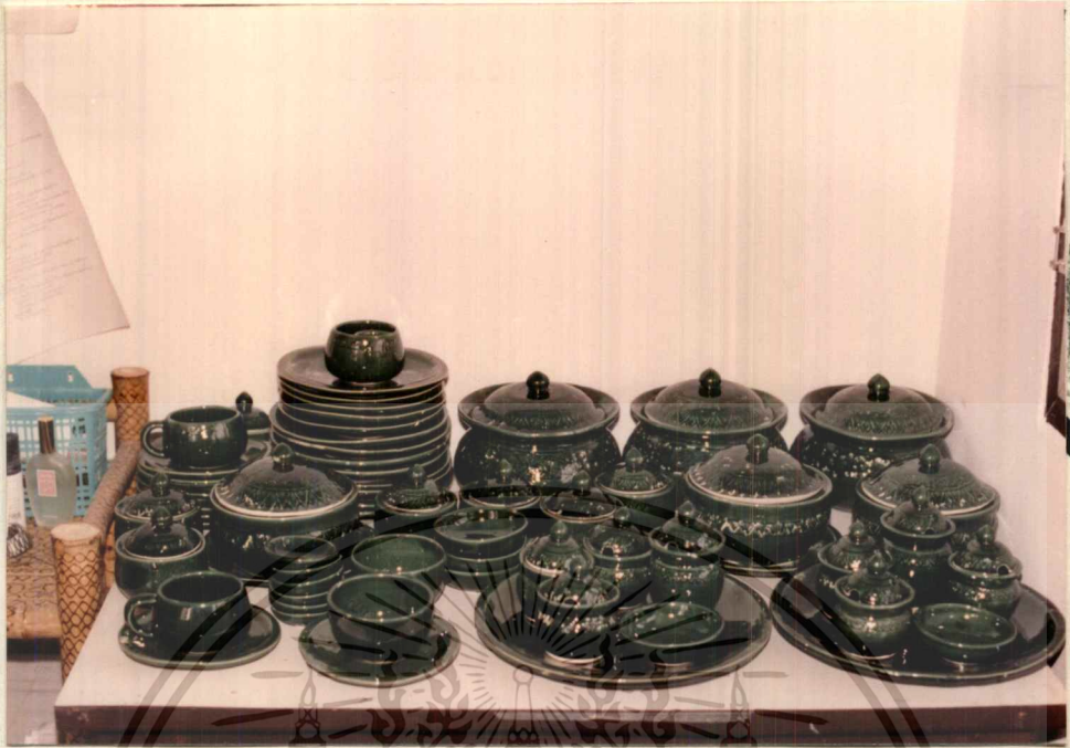
ภาพที่ 147 ภาพผลิตภัณฑ์สำเร็จเนื้อดิน STONE WARE เผาดิน 900°C เผาเคลือบ 1200°C เคลือบเขียวใสธรรมชาติ oxidation
