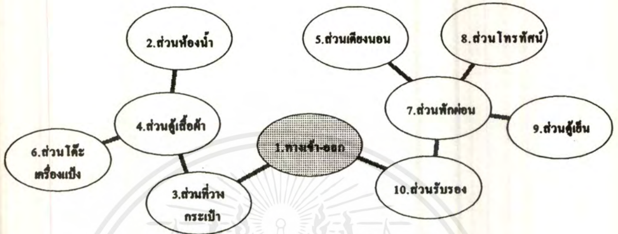
รูปที่ 4.3-34 แผนภูมิความสัมพันธ์รูปฟองส่วนห้องพักพิเศษ
