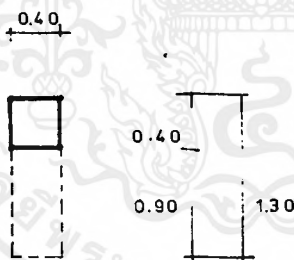
ภาพที่ 169 แสดงพื้นที่ใช้สอยส่วนเก็บของ ต่อ 1 คน ใช้พื้นที่ = 0.5 ตารางเมตร จำนวน 4 คน = 4 x 0.5 = 2 ตารางเมตร
