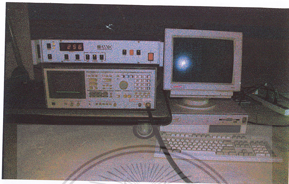
ภาพที่ 4.1 แสดงเครื่องมือที่ใช้ในการทดสอบวัดแพทเทอร์นสายอากาศ
