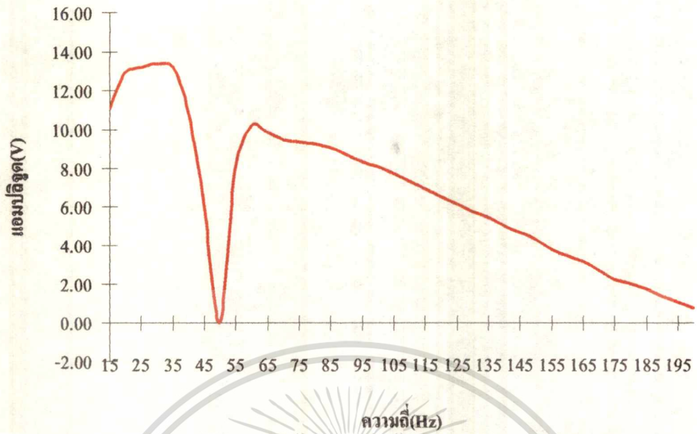
รูปที่ 4.7 ผลตอบสนองทางความถี่ของวงจรรวมทั้ง
