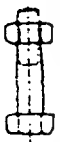
สลักเกลียวหัวหกเหลี่ยม รูตัน มีหัวสลักเกลียว และนอต
