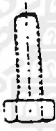
สลักเกลียวยึดชิ้นงาน รูตัน ไม่ต้องใช้ นอต หัวสลักเกลียว โผล่ให้เห็น
