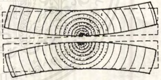
ภาพ ข แสดงการหดตัวของไม้แผ่นทำให้เกิดการโค้งอ รูปปร่างที่โค้งอ จะโค้งงอตรงข้ามกับส่วนของวงปี
