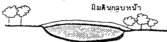
รูปที่ 5.49 ระบบกำจัดขยะแบบถมที่ดิน งานเพื่อการศึกษาเท่านั้น ไม่อนุญาตให้นำไปใช้ประโยชน์ด้านการค้า ไม่ว่ากรณีใดๆทั้งสิ้น อีกทั้งห้ามมิให้ตัดแปลงเนื้อหา และต้องอ้างอิงถึงเจ้าของเอกสารทุกครั้งที่มีการนำไปใช้
