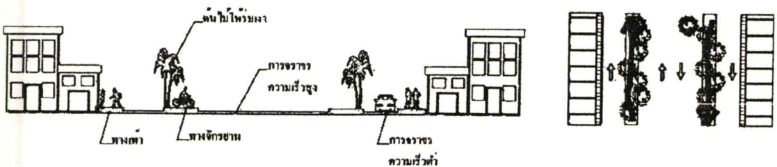
รูปที่ 2.8 รูปแบบเกาะกลางซึ่งปลูกต้นไม้และทางจักรยานแยกเป็น 2 ส่วน
