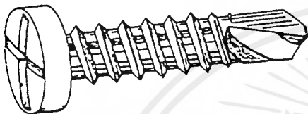
สกรูโลหะแผ่นแบบเจาะรูโคนเกลียวนำได้
