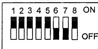
รูปที่ 4.21 ตำแหน่งของคิพสวิตซ์ตัวที่ 7 และ 8 ในการเลือกวงจรตั้งเวลาช่องที่ 2
