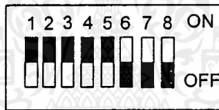
รูปที่ 4.20 ตำแหน่งของคิพสวิตซ์ตัวที่ 7 และ 8 เมื่อตั้งเวลาช่องที่ 1 เสร็จ
