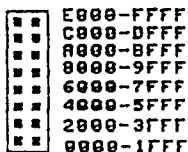
รูปที่ 3.6 การเลือกแอดเดรสเริ่มต้นของหน่วยความจำ
