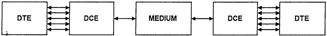
รูปที่ 2.2 ส่วนประกอบของการสื่อสารข้อมูล
