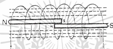
(b) มีกระแสไฟฟ้าไหลผ่านขดลวด ทำให้หน้าสัมผัสติดกัน
