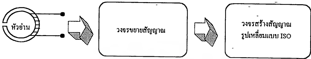
รูปที่ 2.10 ส่วนประกอบพื้นฐานของวงจรสร้างสัญญาณรูปแบบ ISO จากบัตรแถบแม่เหล็ก
