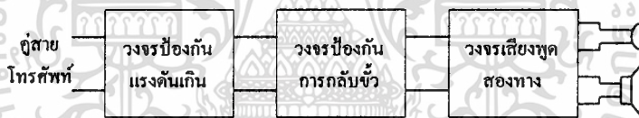
รูปที่ 2.35 บล็อกไดอะแกรมของวงจรควบคุมเสียงพูด
