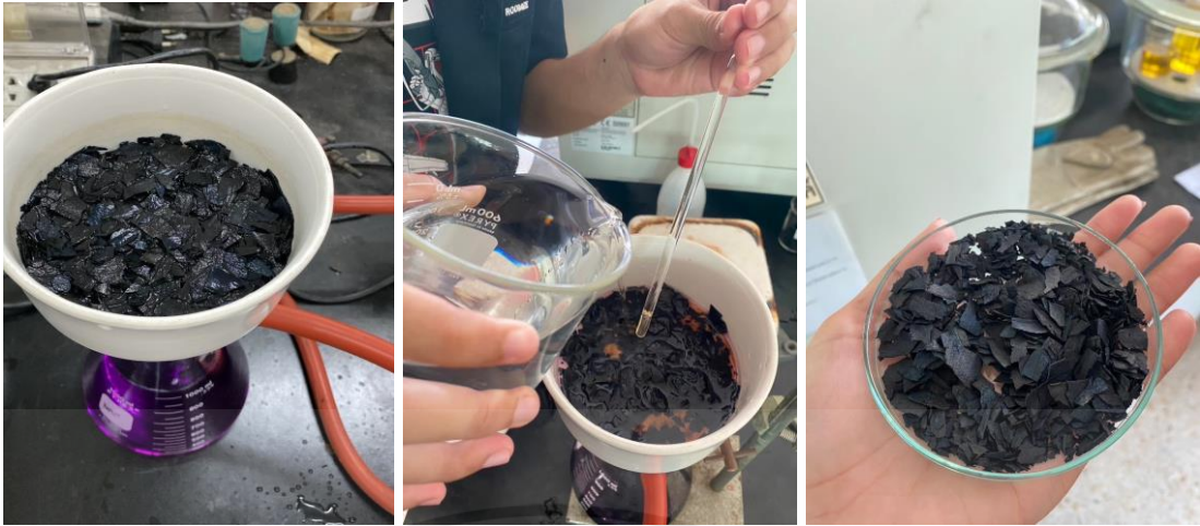
การบำบัดสารเคมีด้วยการล้างและกรองแบบสุญญากาศ
