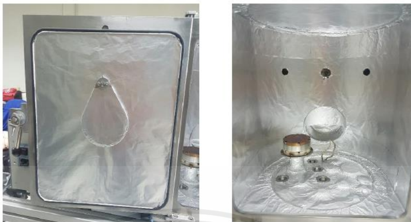
รูปที่ 3.8 ภาชนะสุญญากาศที่ติดอลูมิเนียมฟอยล์
