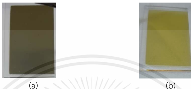
รูปที่ 4.9 ฟิล์มบางอัตราส่วนแก๊สออกซิเจน 6% (a) และ 7.5% (b) ปลุกด้วยเวลา 1 ชั่วโมง ภายใต้อุณหภูมิ 500 องศาเซลเซียส เป็นเวลา 15 ชั่วโมง
