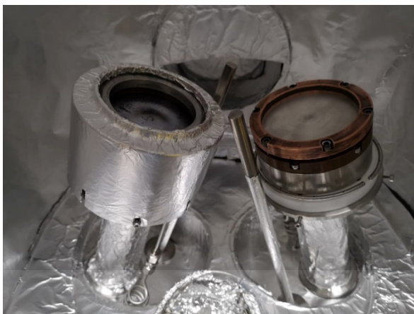
รูปที่ 3.16 หัวแมกนีตรอนที่ทำการประกอบชิ้นส่วนทั้งหมดเรียบร้อยแล้ว
