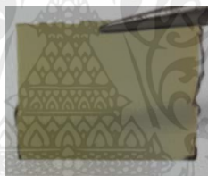
รูปที่ 4.17 ฟิล์มบางที่เตรียมได้จากการใช้กำลังงานคลื่น 150 วัตต์มีอัตราส่วนแก๊สออกซิเจน 6% บนกระจกควอตซ์ ที่มีกระบวนการอบซ้ำ
