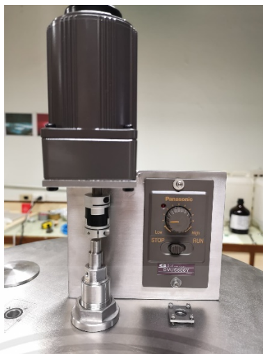
รูปที่ 3.18 มอเตอร์ที่ใช้ทำการหมุนอุปกรณ์ยึดจับ
