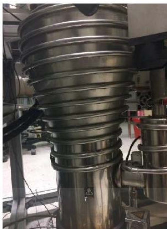
รูปที่ 3.2 (b) ปัมไอฟุ้งกระจายรุ่น Diffstak 160/700 ของบริษัทเอ็ดวาร์ด
