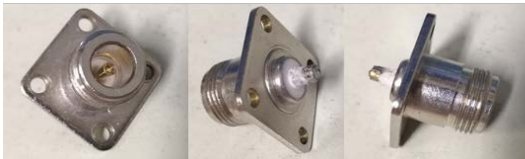
รูปที่ 3.20 อุปกรณ์เชื่อมต่อสายจากเครื่องกำลังคลื่นความถี่วิทยุจ่ายเข้าสู่หัวแมกนีตรอน
