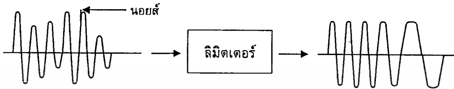
รูปที่ 2.36 วงจรลิมิตเตอร์จะขจัดสัญญาณรบกวนและการเปลี่ยนแปลงทางแอมพลิจูดของสัญญาณ เอฟเอ็ม
