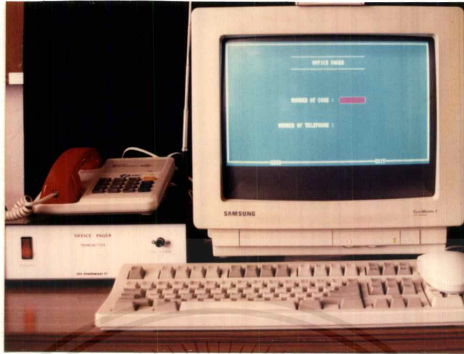
รูปที่ 4.8 แสดงการต่อ โทรศัพท์เข้ากับเครื่องส่ง
