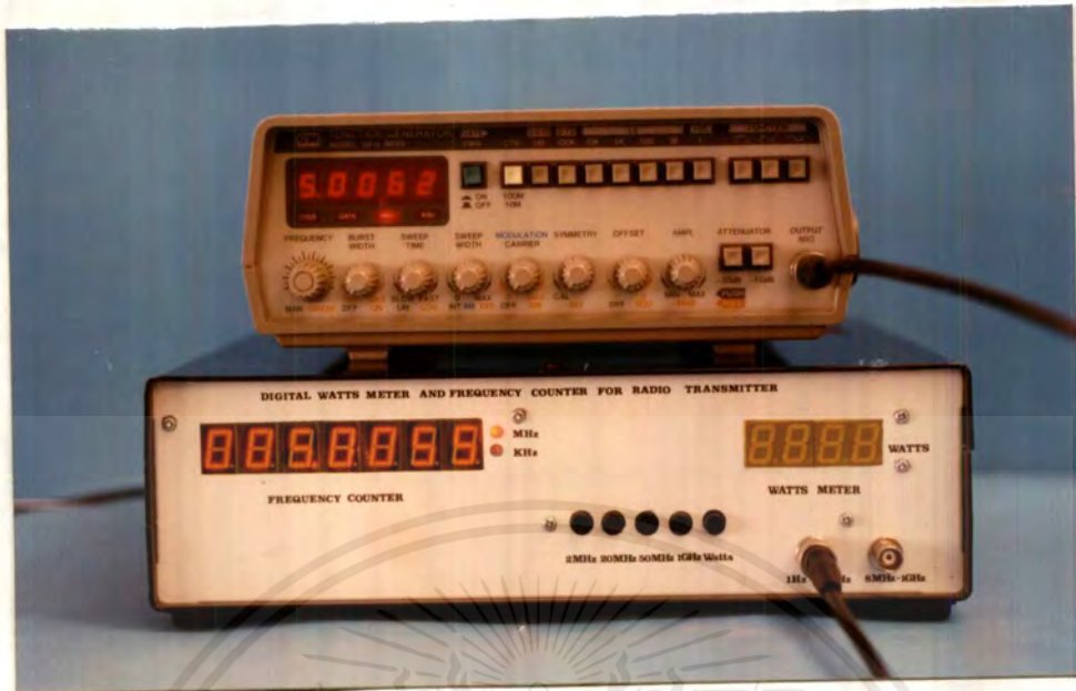
รูปที่ 4.8 ผลการทดลองใช้ดิจิตอลวัตต์มิเตอร์ และเครื่องนับความถี่สำหรับวิทยุสื่อสาร นับความถี่จากเครื่องกำเนิดสัญญาณความถี่ ความถี่ 5 MHz
