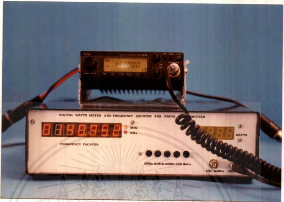
รูปที่ 4.5 ผลการทดลองใช้ดิจิตอลวัตต์มิเตอร์ และเครื่องนับความถี่สำหรับวิทยุสื่อสาร นับความถี่จากเครื่องวิทยุสื่อสาร
