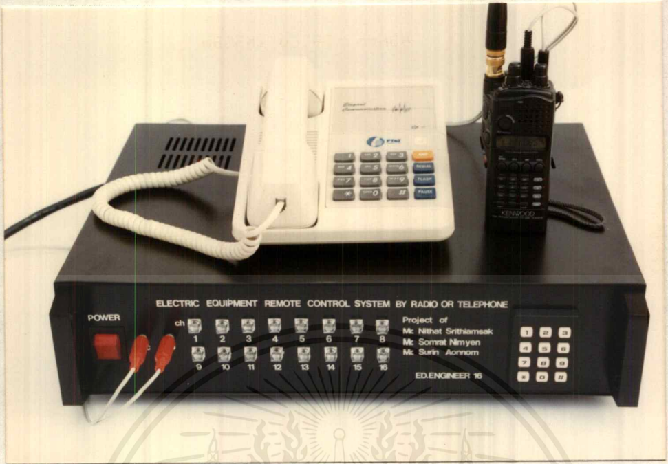
รูปที่ 4.7 การใช้โทรศัพท์และวิทยุแบบมือถือต่อกับระบบควบคุมอุปกรณ์ไฟฟ้า
