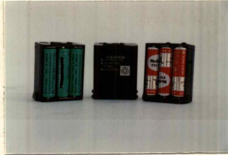
รูปที่ 2.4 แบตเตอรี่แพ็คที่ใช้กับวิทยุแบบมือถือปฏิบัติการ
