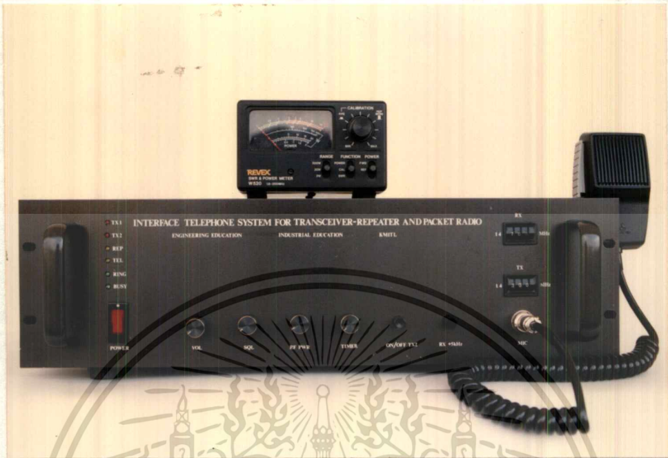
รูปที่ 4.6 แสดงภาพการต่ออุปกรณ์เครื่องวัดกำลังส่งและ SWR เพื่อทดสอบ (ด้านหน้า)
