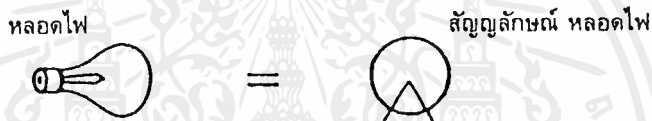
ภาพที่ 65 การใช้สัญลักษณ์ช่วยให้การเขียนรูปร่างวงจรง่ายขึ้น
