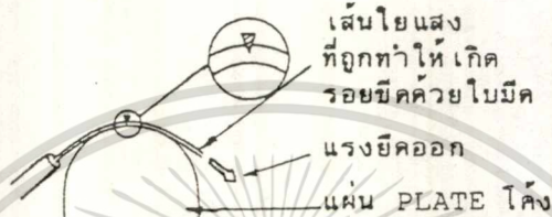
(b) หลักการตัดโดยใช้ FIBER CUTTER
