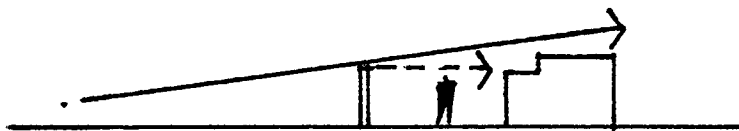
ถ้าแผงกันเสียงอยู่กึ่งกลางระหว่างต้นกำเนิดเสียงกับอาคาร จะให้ผลเลวที่สุด
