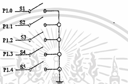
รูปที่ 2.9 แสดงการเชื่อมต่อสวิทช์โดยตรงกับพอร์ท
