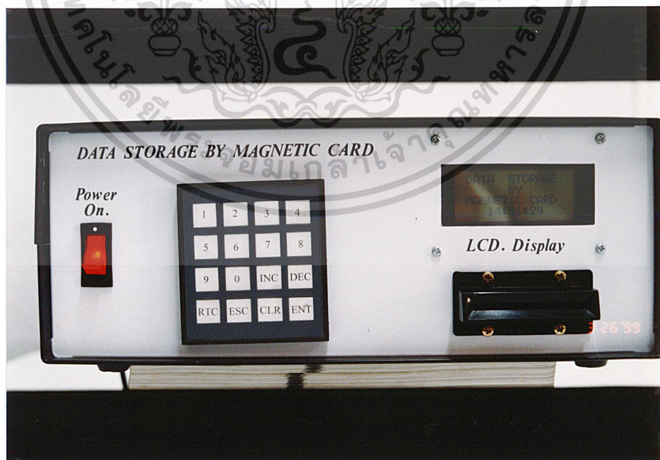
รูปที่ 3.38 แสดงเครื่องต้นแบบของเครื่องเก็บข้อมูล โดยผ่านบัตรแถบแม่เหล็ก
