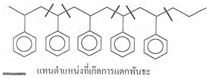
รูปที่ 4.26 แสดงแนวทางการสลายตัวของพอลิสไตรีนที่เกิดเป็น \alpha -methyl styrene
