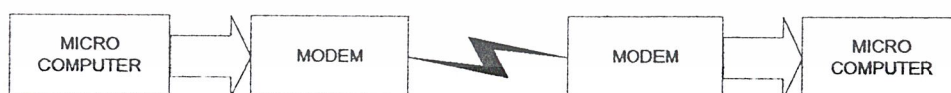
รูปที่ 2.11 แสดงการใช้ RS232C เชื่อมต่ออุปกรณ์
