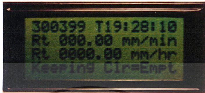
รูปที่ 4.12 แสดงหน้าจอแอลซีดีเมื่อมีการกดคีย์ลบข้อมูลในหน่วยความจำ (RAM)
