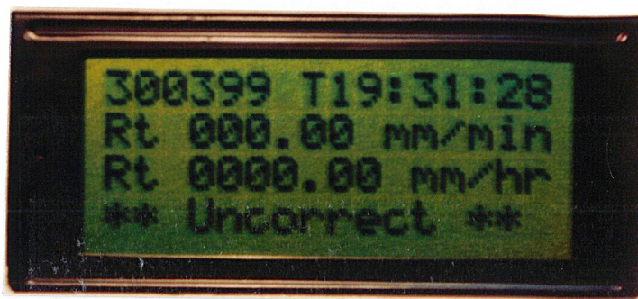
รูปที่ 4.15 แสดงการทำงานการลบข้อมูลในหน่วยความจำ (RAM) โดยเป็นสภาวะหลังจากการมีการตรวจสอบรหัสผ่านว่าไม่ถูกต้อง
