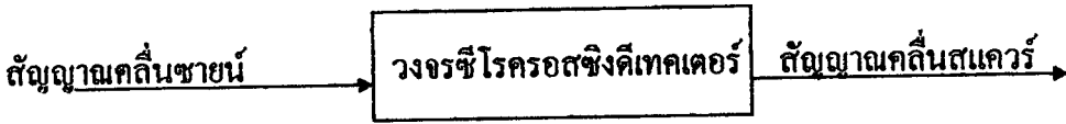
รูปที่ 2.5 แสดงการแปลงสัญญาณคลื่นไซน์เป็นสัญญาณคลื่นสแควร์ด้วยวงจรซีโรครอสซิงดิเทคเตอร์
