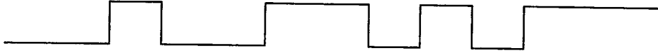
รูปที่ 2.5 แสดงสัญญาณ เอพาทพุต ของ PRBS ขนาด 4 บิต
