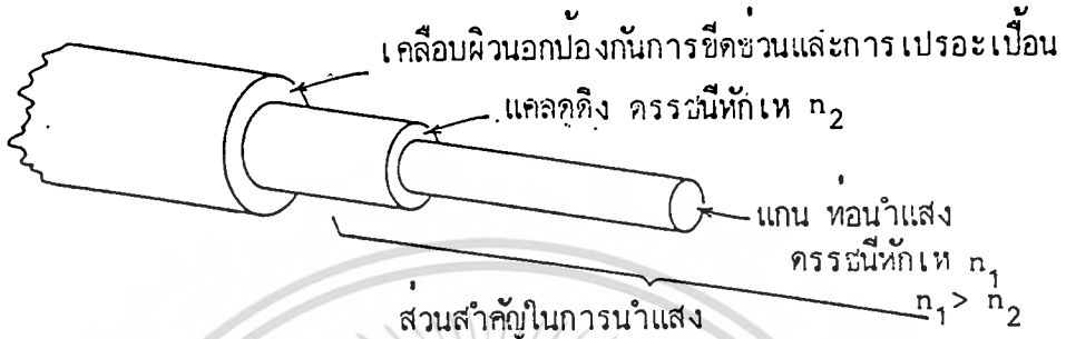
ภาพที่ 2.2 แสดงส่วนสำคัญของใยนำแสงคือส่วนแกน แคลคูลิง และส่วนเคลือบภายนอก
