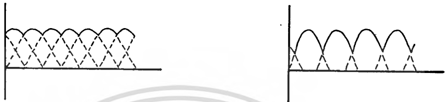
ก) วงจรแปลงกระแสไฟฟ้าสามเฟสแบบเต็มช่วงคลื่น
