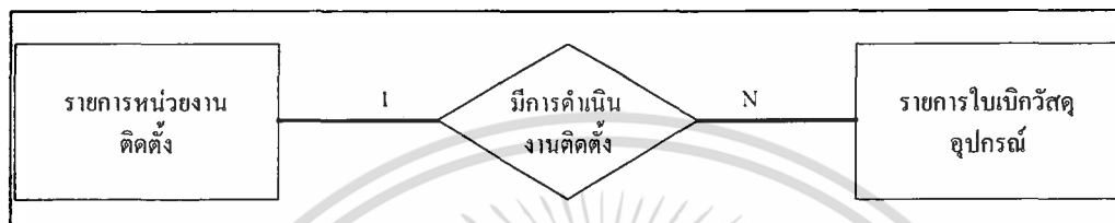
ภาพที่ 11 แผนภาพโมเดล E-R แสดงความสัมพันธ์ระหว่างเอนทิตีหน่วยงานติดตั้งและรายการใบเบิกวัสดุอุปกรณ์
